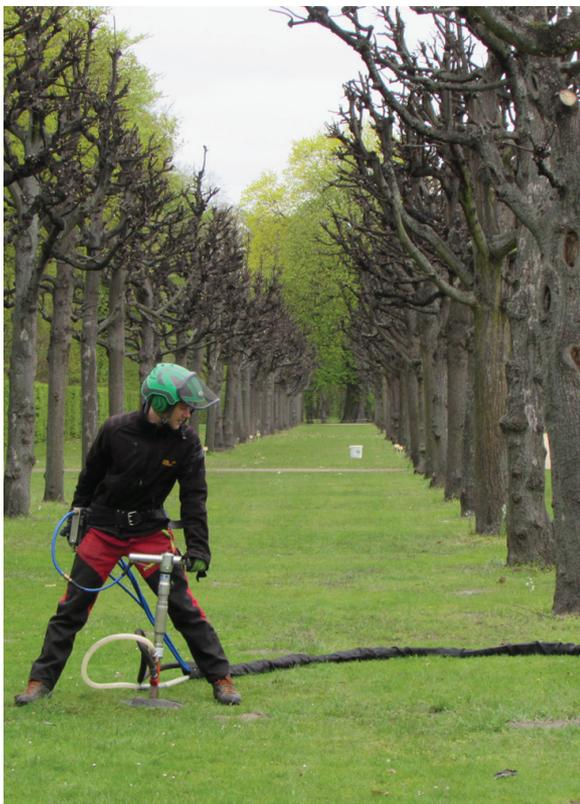
**Abbildung 3: Bodeninjektion von Bodenhilfsstoffen mittels einer Injektionslanze in den Wurzelbereich der Bäume mit dem Vogt Geo Injector trolley (Vogt Baugeräte GmbH).**
