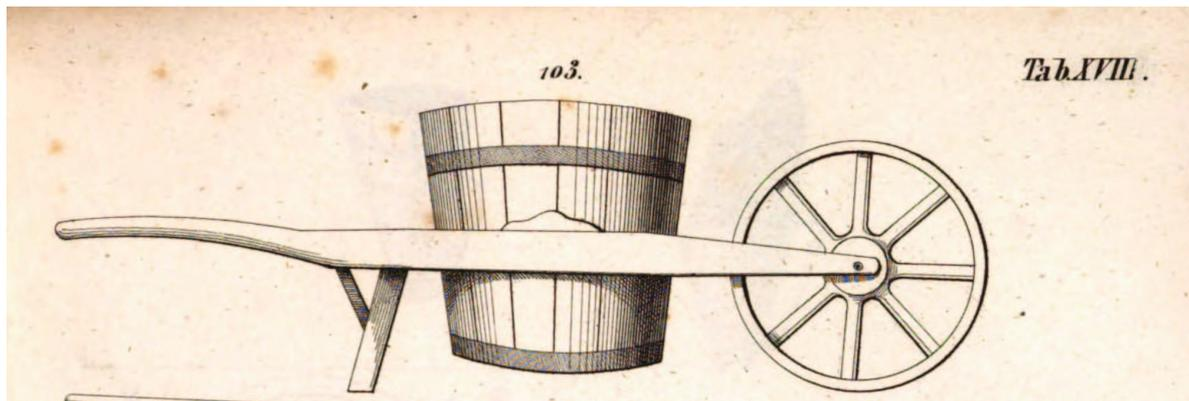
Abbildung 1: Fahrbarer Bottich (Wassertine) um 1850.
